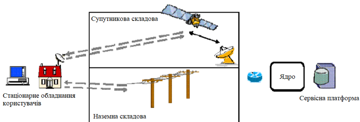
Рис. 2. 5 - Двосторонній супутниковий зв'язок, реалізований в наземній мережі для фіксованого терміналу
