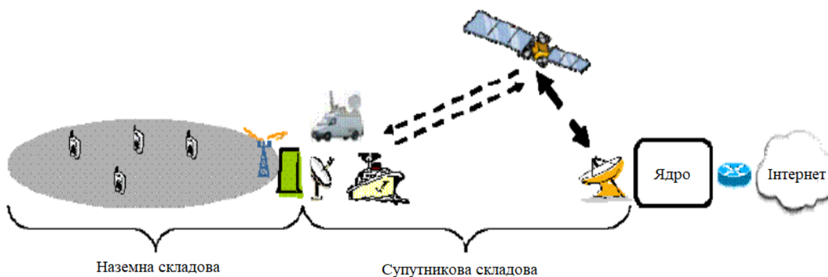
Рис. 2.6 - Резервне обслуговування мобільних послуг із використанням супутникового сегмента в гібридній системі
