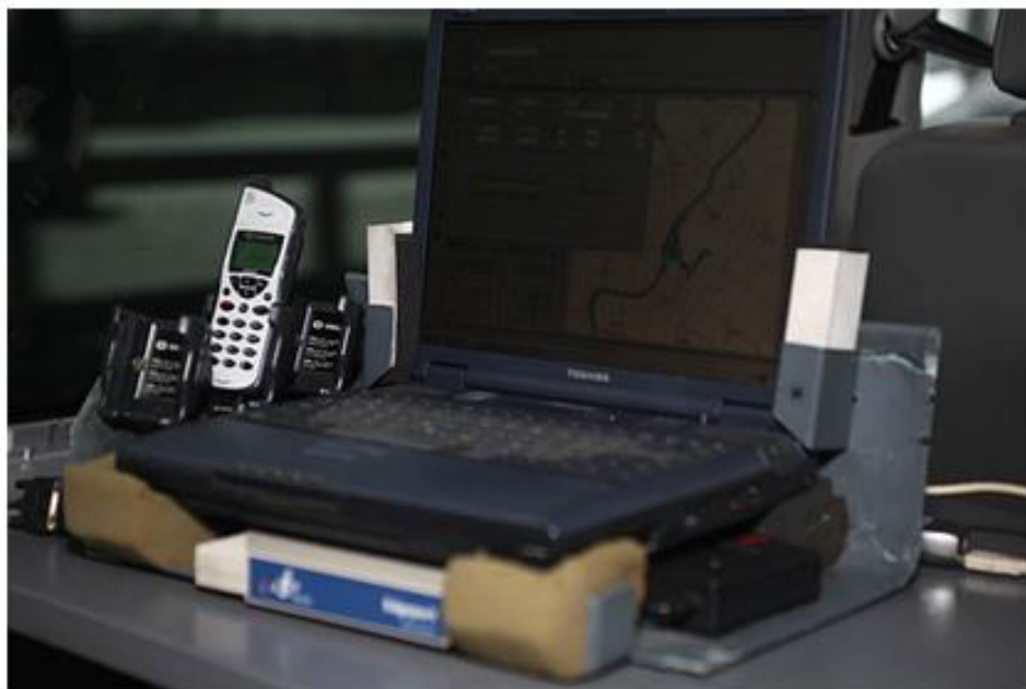
Комплекс вимірювання якості стільникового покриття компанії Beeline
