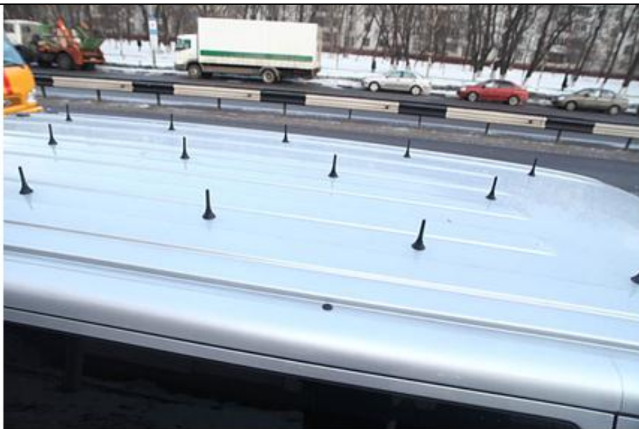
Антени стільникових терміналів, розташованих у вимірювальному комплексі оператора Beeline
