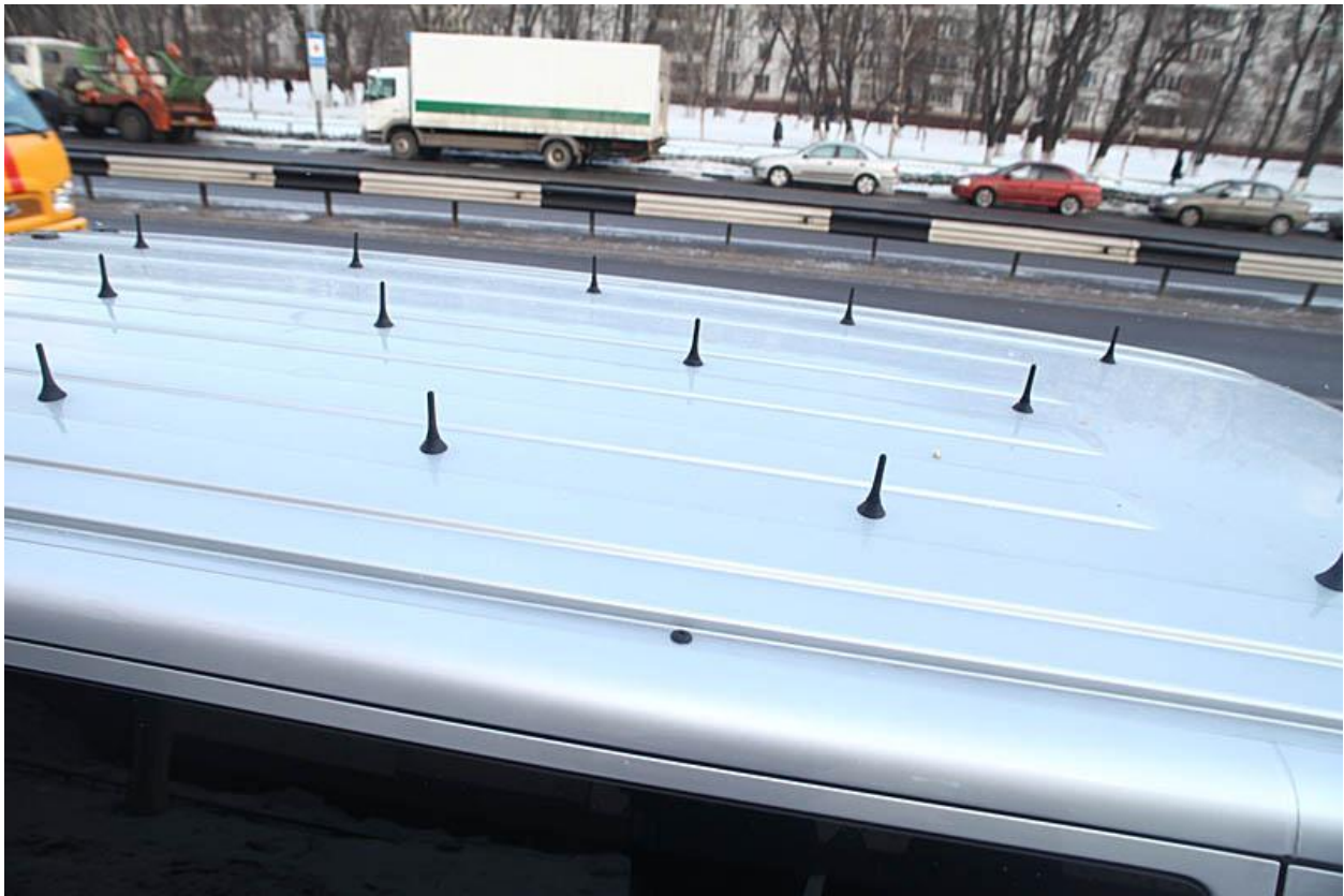
Рис. 1.4.2.1 Антени стільникових терміналів, розташованих у вимірювальному комплексі оператора Beeline.
