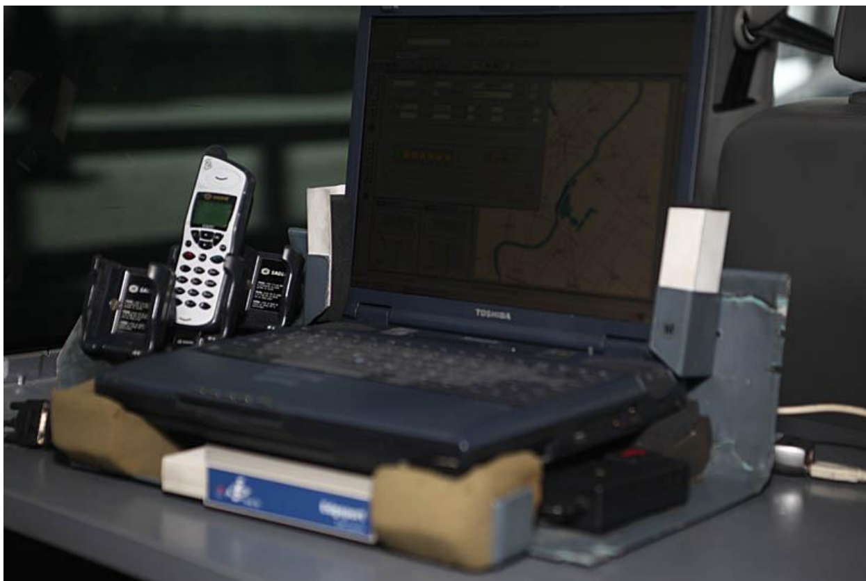
Рис. 1.4.2.2 Комплекс вимірювання якості стільникового покриття компанії Beeline.
