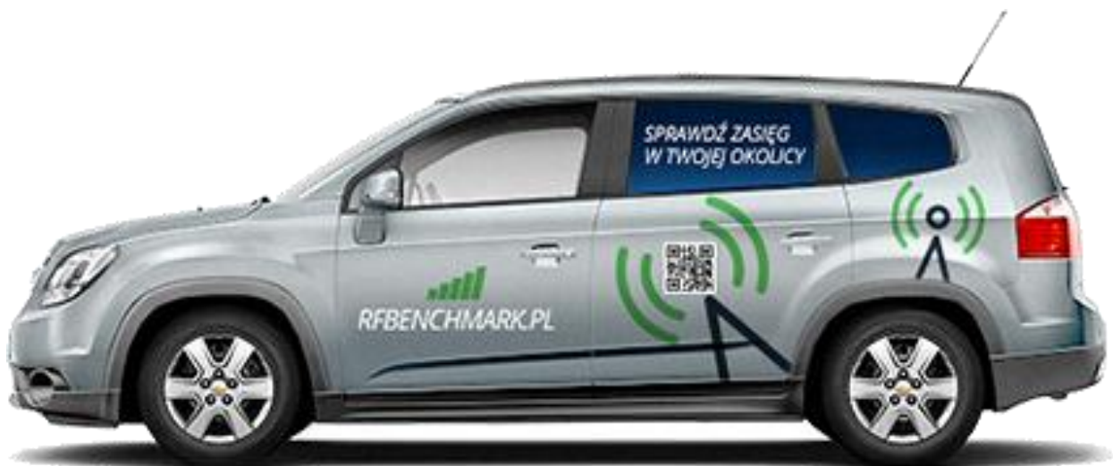
Рис. 1.4.3.1 Комплекс вимірювання якості стільникового покриття компанії RFBENCHMARK.
