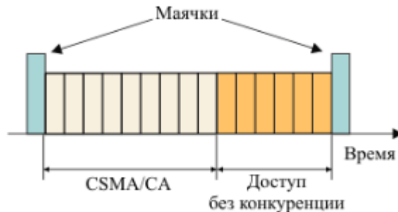
Рисунок 1.3. Структура суперфрейма с гарантованими часовими слотами
