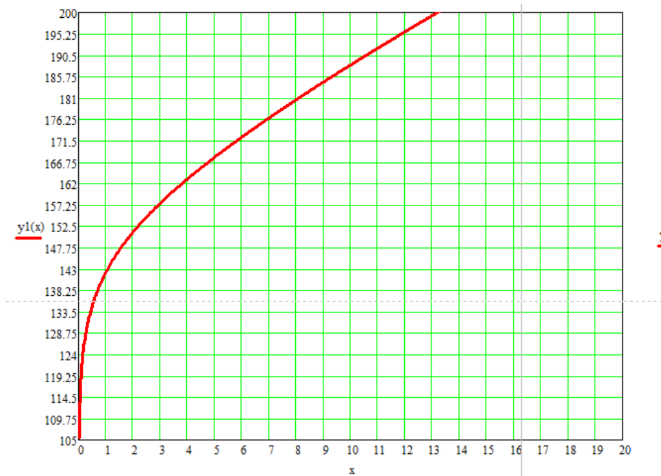
Рис. 2.15 Графік залежності f(R_{[\text{км}]}) від параметра R_{[\text{км}]} при \gamma_{\text{д}} [\text{дБ/км}] = 0 та при частоті передачі 220 ГГц
