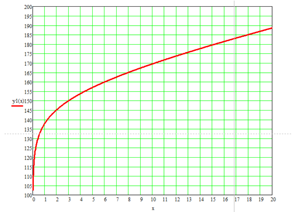
Рис. 2.14 Графік залежності f(R_{[км]}) від параметра R_{[км]} при \gamma_d [дБ/км] = 0 та при частоті передачі 160 ГГц
