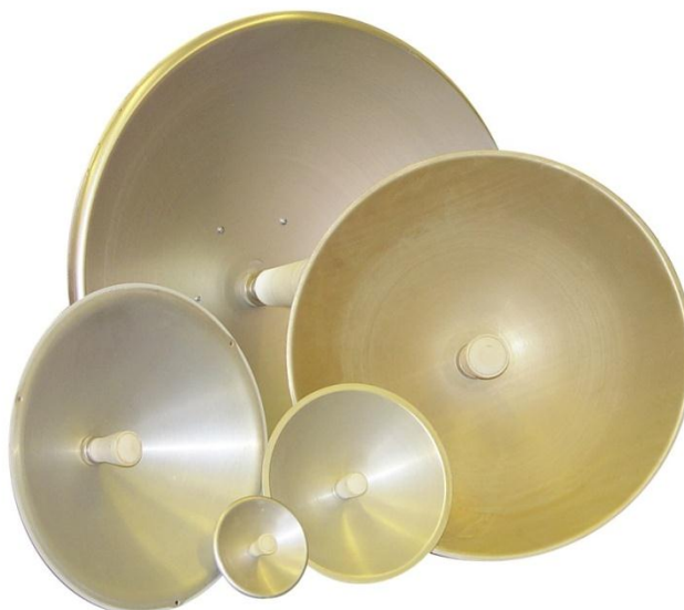
Рис.3.15 Антена Кассегрена Elva-1
