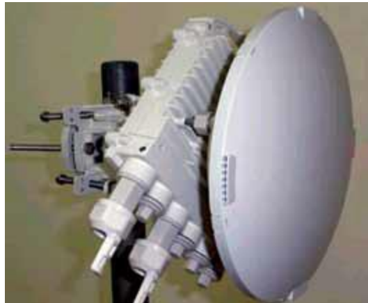
Рис.1.13 Радіорелейна станція E-діапазону компанії E-band Communications
