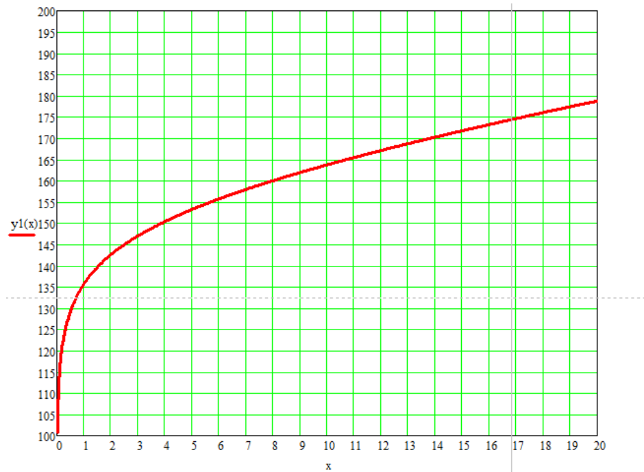
Рис. 2.12 Графік залежності f(R_{[\text{км}]}) від параметра R_{[\text{км}]} при \gamma_{\text{д}} [\text{дБ/км}] = 0 та при частоті передачі 130 ГГц
