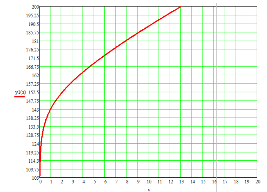
Рис. 2.16 Графік залежності f(R_{[\text{км}]}) від параметра R_{[\text{км}]} при \gamma_{\text{д}} [\text{дБ/км}] = 0 та при частоті передачі 235 ГГц
