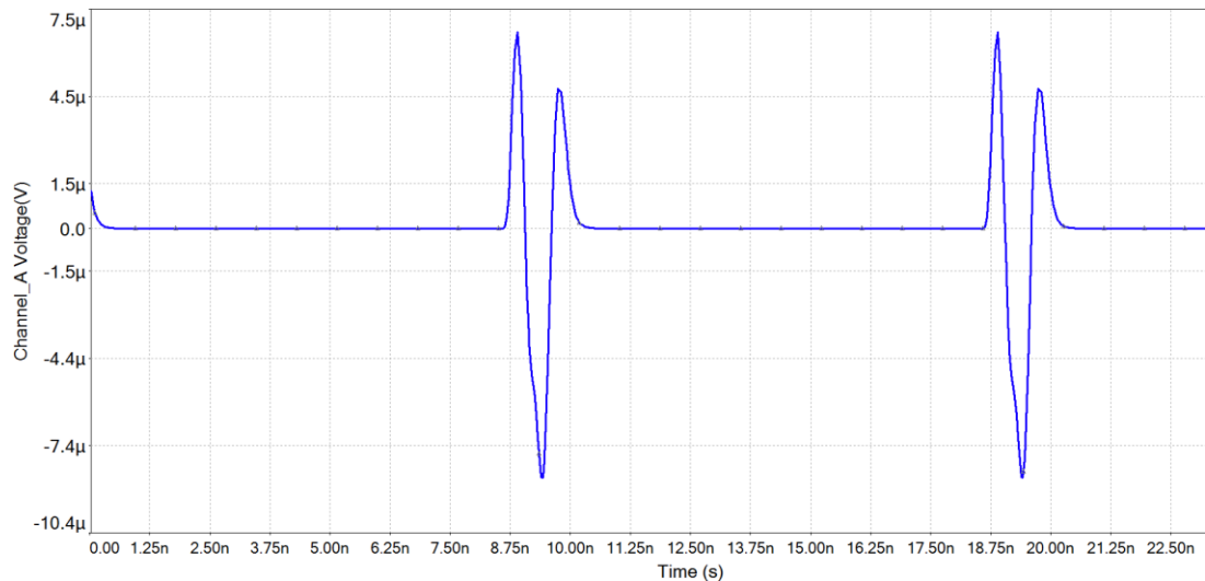
Рис.4.28 UWB сигнал на виході антени UWB приймача (на виході другого кола диференціювання)
