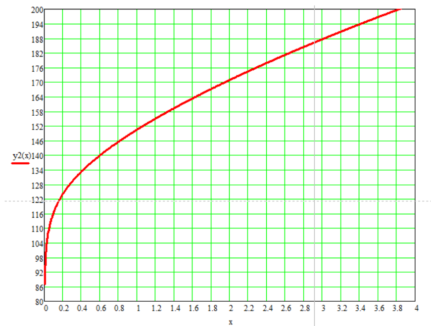
Рис. 2.18 Графік залежності f(R_{[\text{км}]}) від параметра R_{[\text{км}]} при \gamma_{\text{д}} [\text{дБ/км}] = 15,5 та при частоті передачі 130 ГГц
