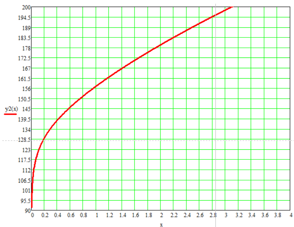
Рис. 2.21 Графік залежності f(R_{[\text{км}]}) від параметра R_{[\text{км}]} при \gamma_{\text{д}} [\text{дБ/км}] = 15,5 та при частоті передачі 220 ГГц
