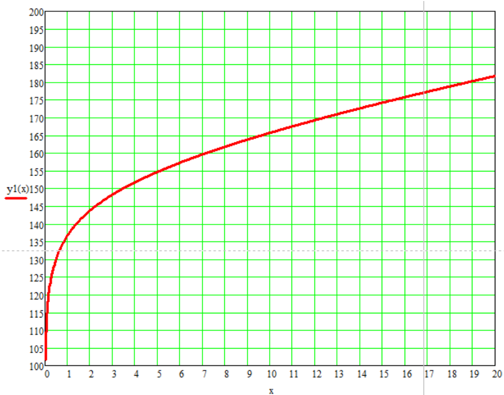
Рис. 2.13 Графік залежності f(R_{[км]}) від параметра R_{[км]} при \gamma_d [дБ/км] = 0 та при частоті передачі 145 ГГц
