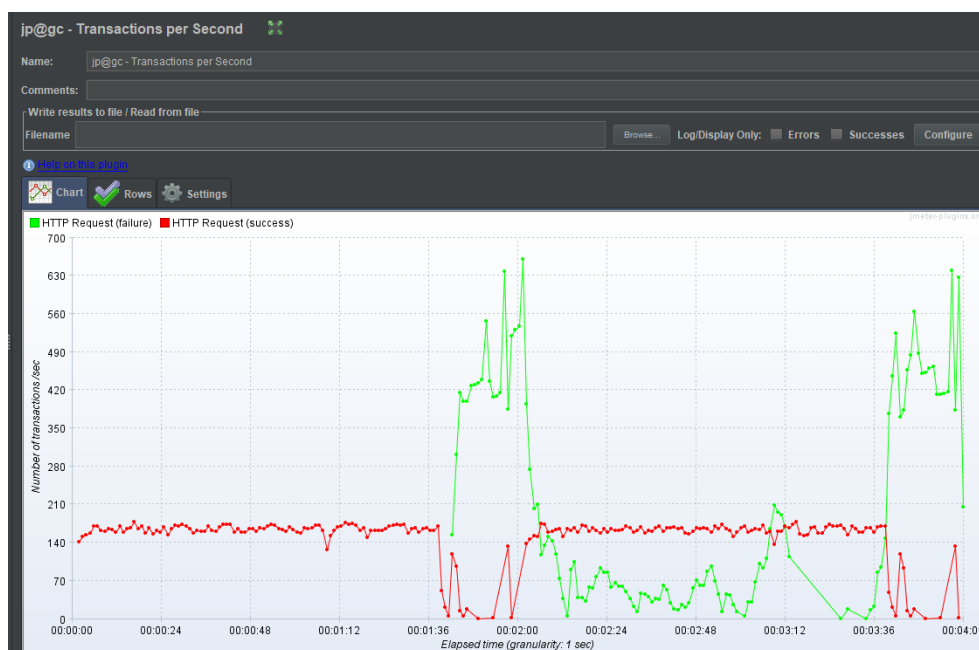
Рисунок Error! No text of specified style in document. 50- графік кількості транзакцій при 180 потоках і 42% помилок
