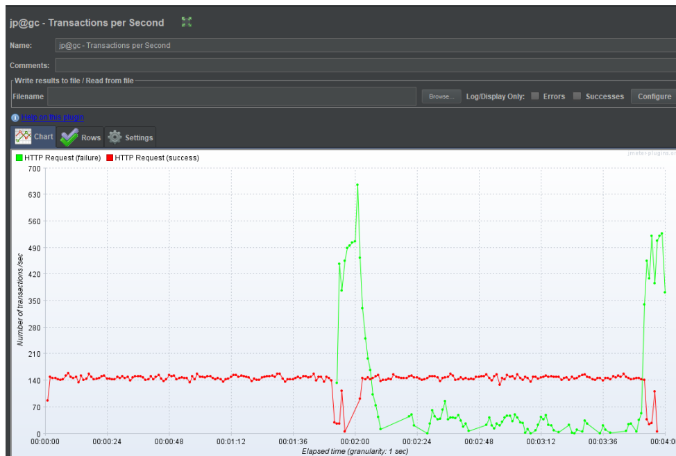
Рисунок Error! No text of specified style in document..51 - графік кількості транзакцій при 160 потоках і 25% помилок
