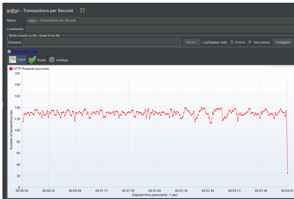
Рисунок Error! No text of specified style in document..52 - графік кількості транзакцій при 140 потоках і 0% помилок
