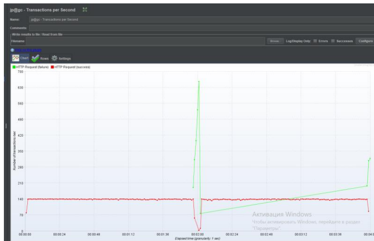
Рисунок Error! No text of specified style in document. 47- графік кількості транзакцій при 140 потоках і 8% помилок
