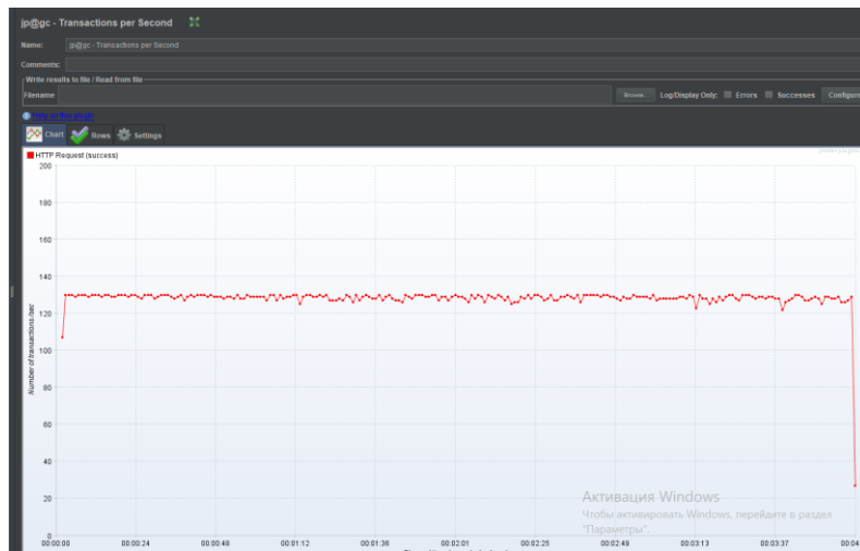
Рисунок Error! No text of specified style in document. 48- графік кількості транзакцій при 130 потоках і 0 помилок
