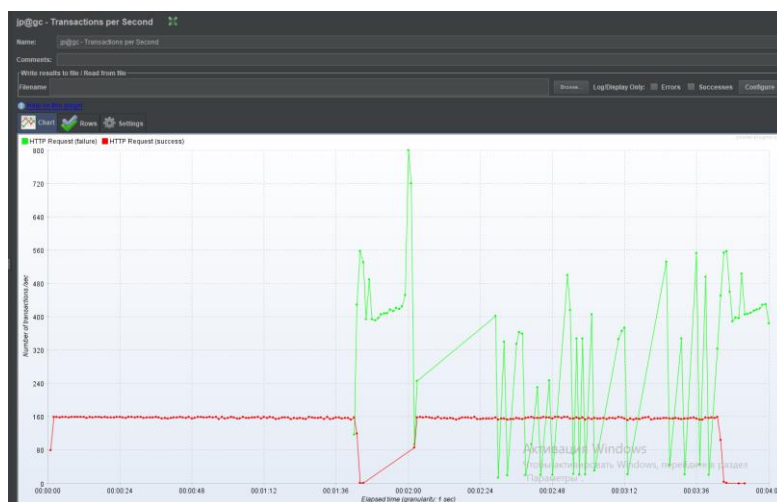
Рисунок Error! No text of specified style in document. 46- графік кількості транзакцій при 160 потоках і 43% помилок
