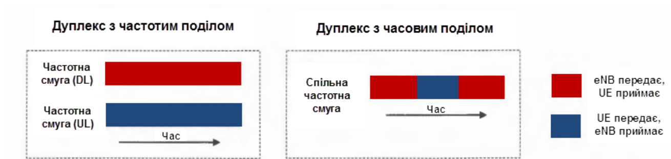
Рисунок 1.10. Ілюстрація принципів дуплексу з частотним і часовим поділом
