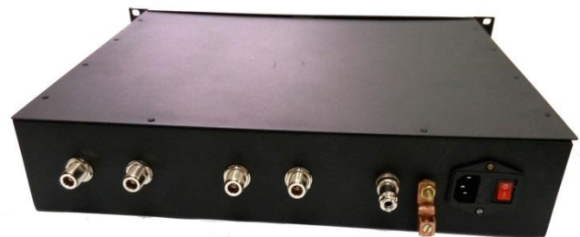
Рис. 9.3. Зовнішній вигляд модемного пристрою (з права на ліво: роз'єм типу WTY0122 з кнопкою «Живлення 220В», DN 3 - управління, N типу - сигнал ПЧ RX1, N типу - сигнал ПЧ TX1, N типу - сигнал ПЧ RX2, N типу - сигнал ПЧ TX2)
