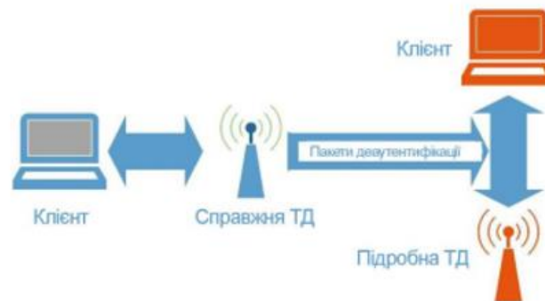
Рис. 3.10. Заходу захисту від підроблених ТД, яка не підключена до провідної мережі
