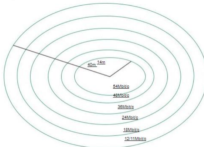
Рис. 1.10. Радіус дії в частотному діапазоні 2,4 ГГц (802.11g) при модуляції OFDM
