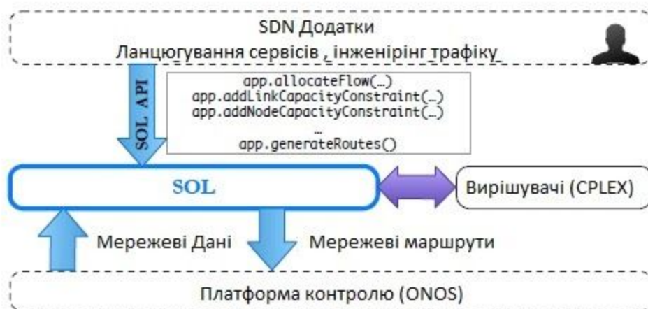
Рисунок 2: Розробники використовують високорівневі SOL API для специфікації оптимізаційних цілей та обмежень. SOL генерує близькі до оптимальних рішення та виробляє конфігурації для пристроїв що є вхідними даними до рівня контролю SDN мережі.
