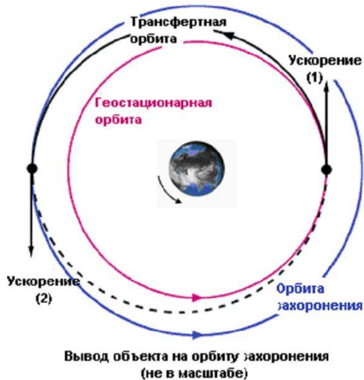
Рис.1.8. Схема переведення ГСС на орбіту поховання.
