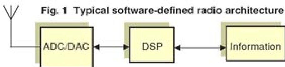
Рис. 1.2 Спрощена архітектура типового SDR.
