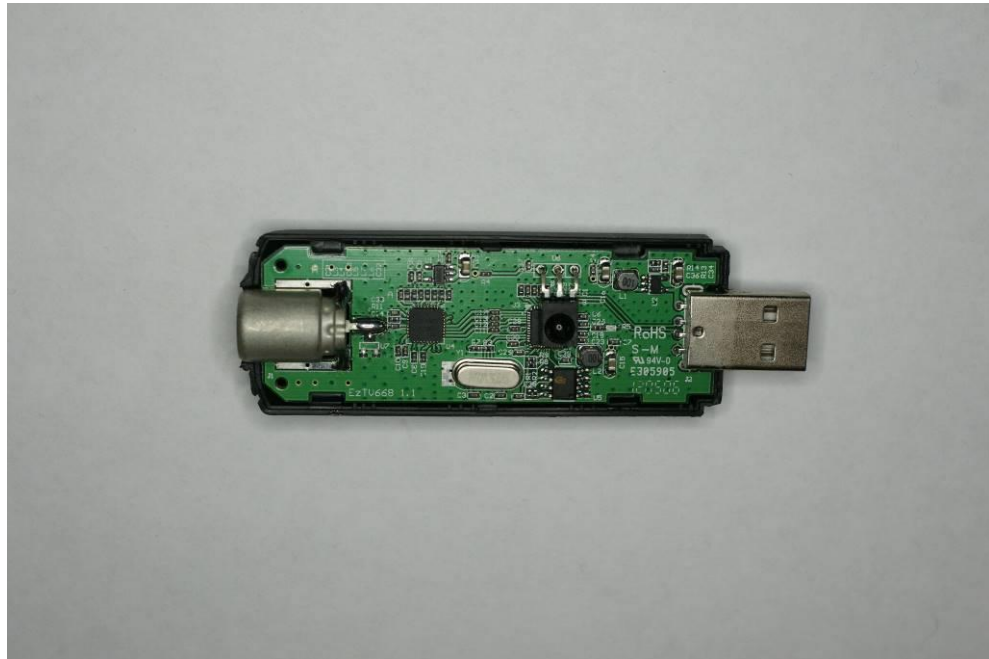
Рис. 2.4 Типічний приймач на основі RTL2832 - EzTV668
