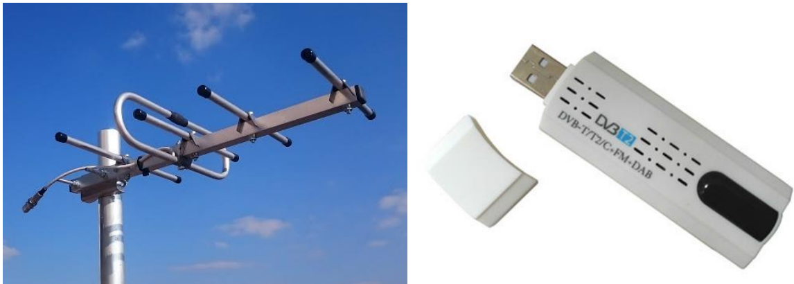
Рис.3.11. а) Антенa МХ-ДМХ «Хвильовий канал» ; б) RTLSDR приймач Astrometa DVB-T2
