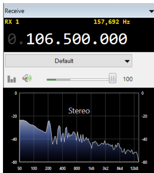
Рис.2.11. Вікно налаштування частоти прийому сигналу та відображення спектру демодульованого сигналу.
