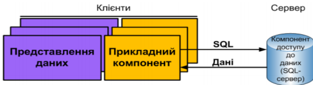
Рисунок 2.2 Схема взаємодії RDA-моделі
