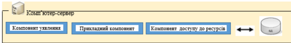
Рисунок 1.1 Модель файлового сервера (FS)
