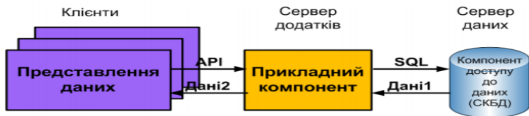
Рисунок 2.4 Схема взаємодії AS-моделі
