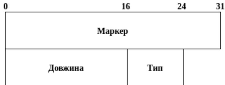
Рис. 10. Структура загального заголовку BGP
